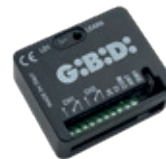
DRS 4335 Ricevente 2 canali universale
