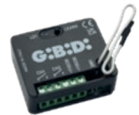
DRS 4336 Ricevente 2 canali universale – alimentazione 115-230Vac
